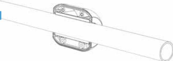
**3** Montaggio guscio anteriore + feltrino 2; inserimento viti anteriori e valvolina di tenuta nelle apposite sedi
